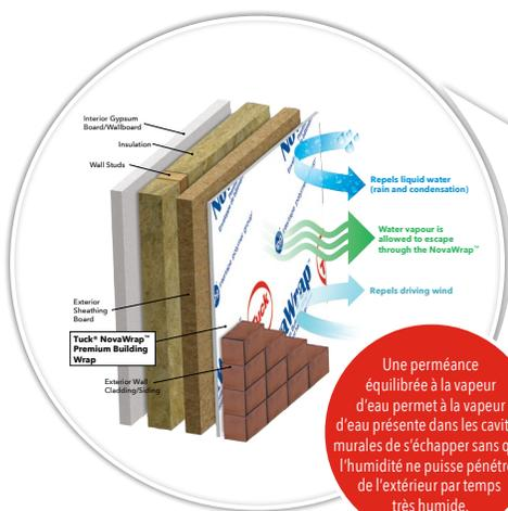
Une perméance équilibrée à la vapeur d'eau permet à la vapeur d'eau présente dans les cavités murales de s'échapper sans que l'humidité ne puisse pénétrer de l'extérieur par temps très humide.
